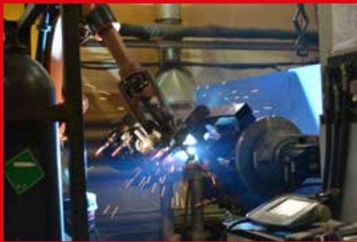
Робототехнический комплекс сварки балок осей
