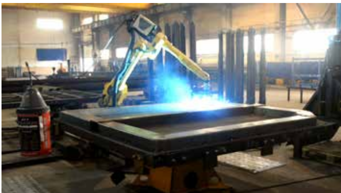
Робототехнический комплекс сварки передних и задних бортов
